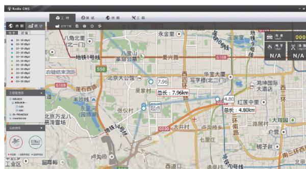
用于两点间直线距离测量。选中导航栏中的测量距离工具, 鼠标移动到地图区域, 单击开始锚点, 右键结束锚点, 距离会实时测量并显示在锚点的右侧。
