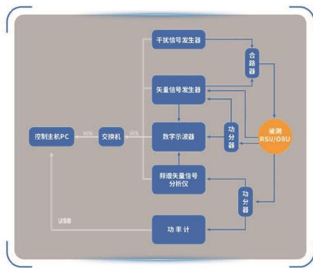
测试系统框架如上图所示，通过安装有核心控制软件 ETC Runsys 的 PC 经过交换机与系统内的硬件设备相连接，使用软件对系统内的设备进行配置，控制信号的收发从而对 RSU 与 OBU 进行自动化测试。
