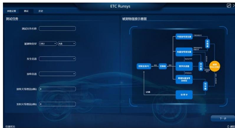
在测试任务界面根据被测物的类型新增测试任务，还可根据被测物连接示意图检查物理链路是否连接正确。
