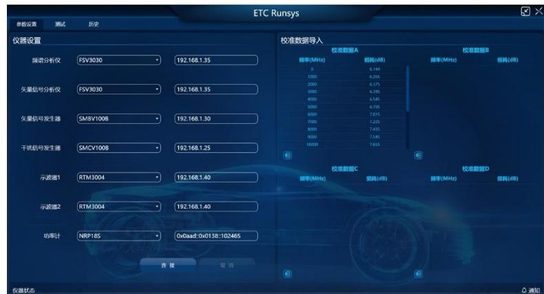
参数设置功能中可以配置不同的测试设备以及设备所对应的型号，配置完成后输入对应设备的 IP 即可与设备相连接并控制。连接测试设备后可以根据需要导入测试仪器的校准数据，确保后续测试结果的准确性。
